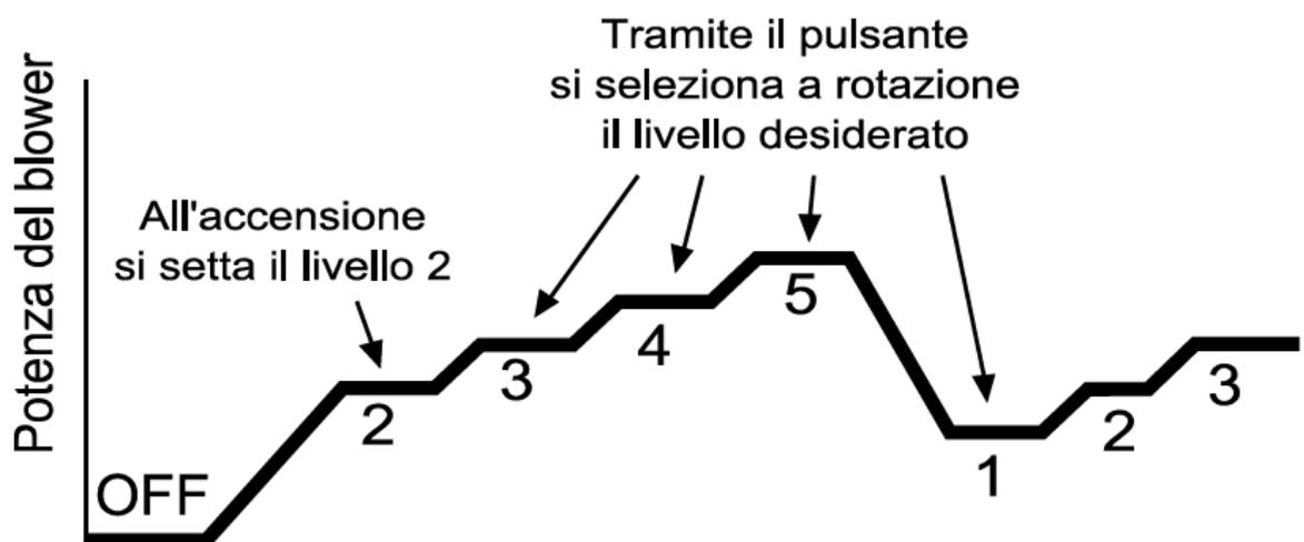
Premendo per 2" il tasto 'Velocità', si avvia la funzione di VARIAZIONE DI VELOCITÀ AUTOMATICA che aumenta e diminuisce autonomamente.
